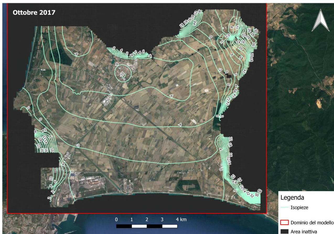
Fig. 6.1. Carico idraulico simulato per l'acquifero al 27 Ottobre 2017.
