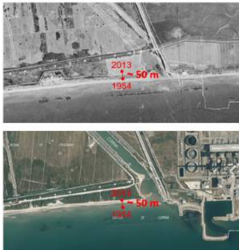
Fig. 4.21 - Confronto ortofoto 1954 e 2013 presso foce Cornia nuova (loc. Torre del Sale di Piombino), con riportato il grafo della CTR su entrambe le immagini, dal quale si evince un arretramento della linea di costa pari a circa 50 m (ns elaborazione su basi www502.regione.toscana.it/geoscopio/ortofoto.html ).
